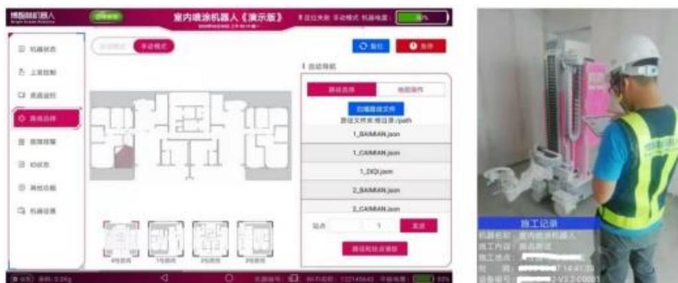
图 2-6 喷涂机器人 BIM 路径规划操作示意图
