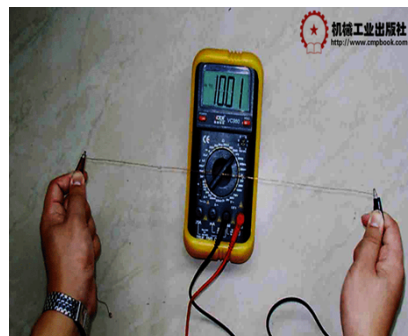
图3 电阻应变片的工作原理
