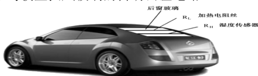
(a) 汽车后窗湿度传感器的安装示意图
