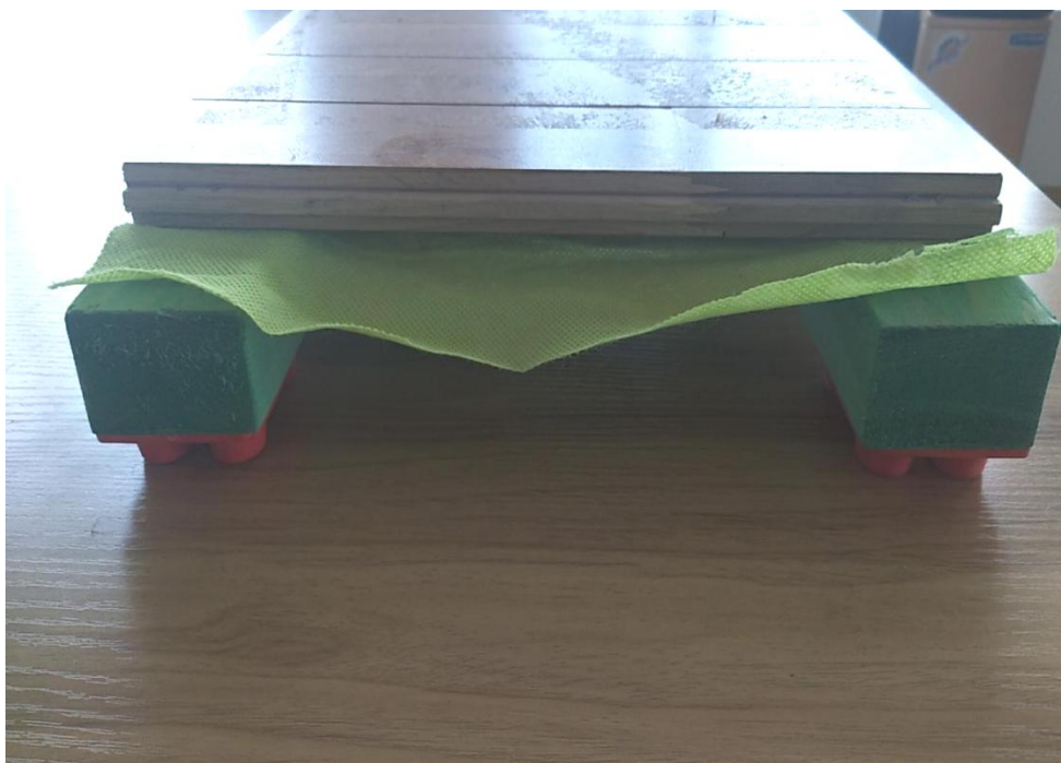
一字型单层龙骨结构图（无多层板）实物构造模型
